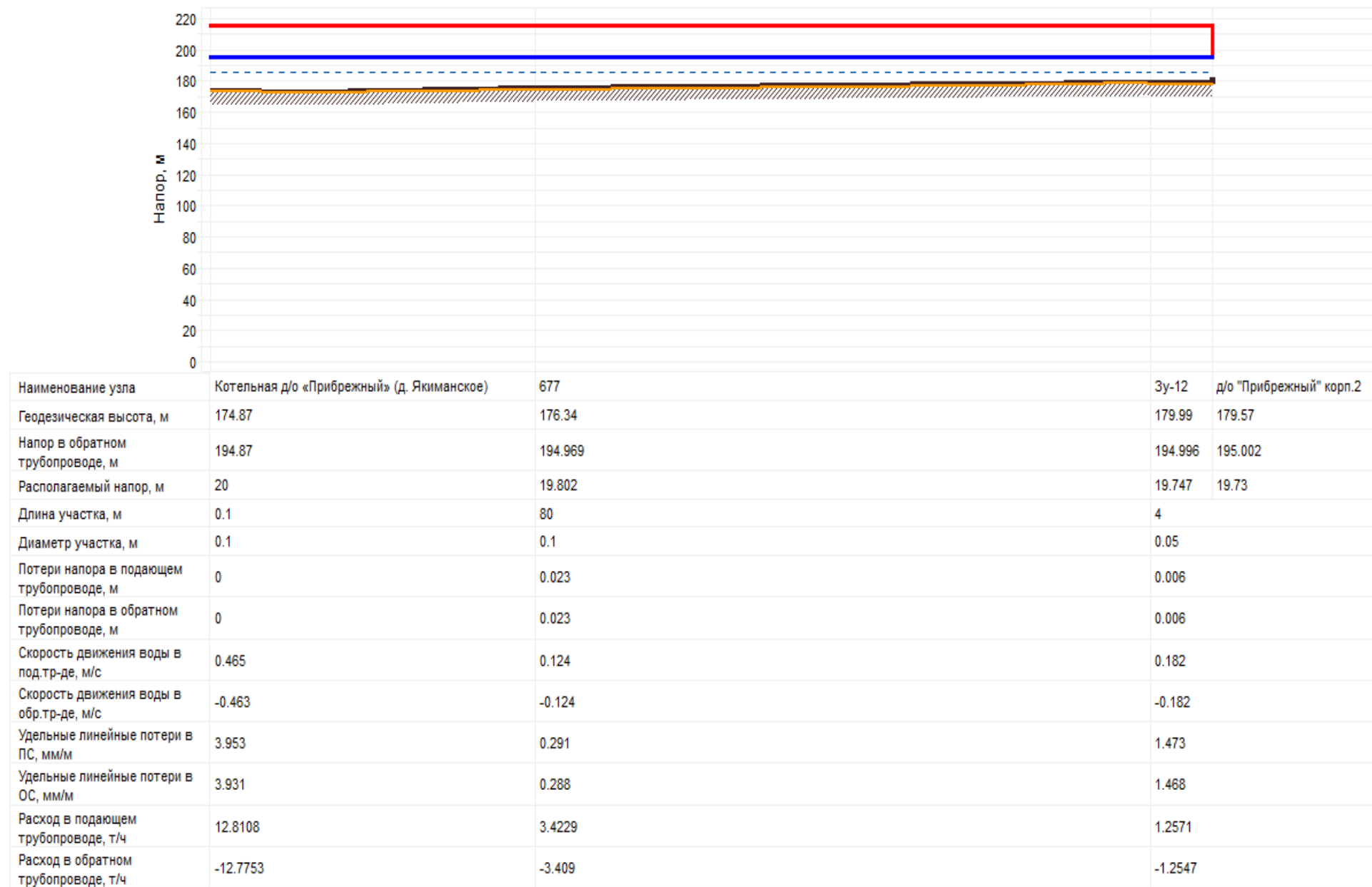
Рисунок 22 – Пьезометрический график тепловых сетей от котельной «Прибрежный»
