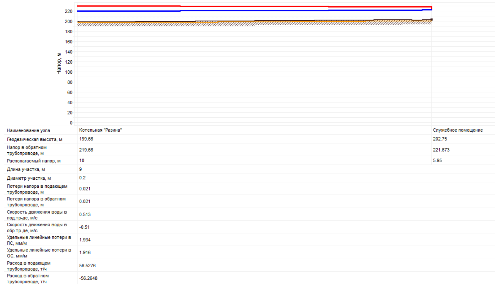
Рисунок 32 – Пьезометрический график тепловых сетей от котельной №01010074
